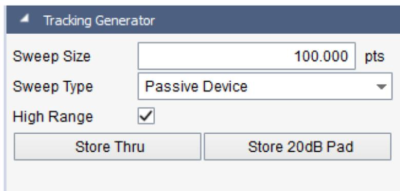
Рис. 5. Панель управления процессом измерения АЧХ.
