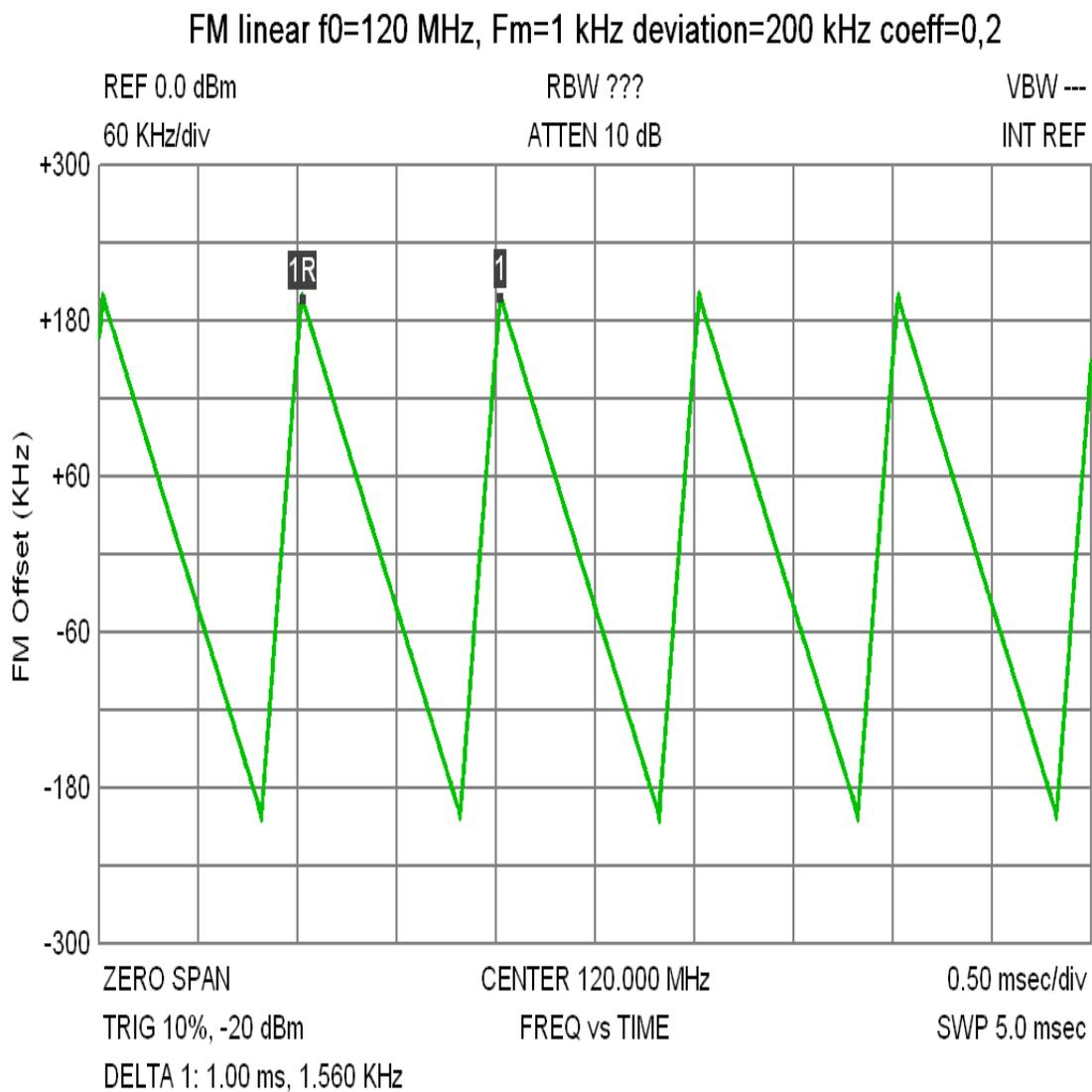
Несущая частота 120 МГц, импульсная частотная модуляция,
