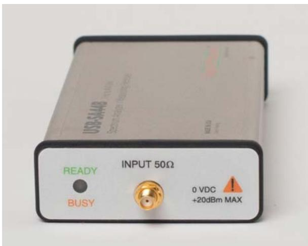
На **передней панели** расположен ВЧ вход. Входное сопротивление –  $50\Omega$ , тип разъема – SMA. Уровень сигнала по входу прибора не должен превышать значения +20 дБм, иначе прибор может выйти из строя. **Также недопустима постоянная составляющая напряжения в СВЧ сигнале.** Когда прибор готов к работе, светодиод READY/BUSY (готов/занят) светится зеленым; оранжевым – когда идет обмен данными с компьютером.
